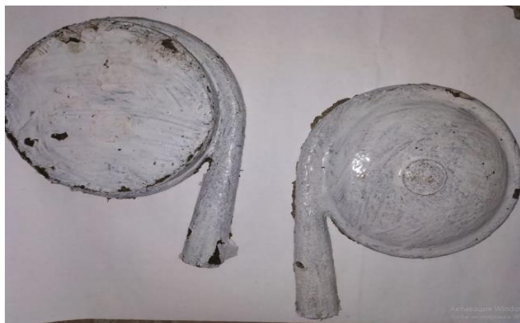
4 Сурет - Қалыптарды құюға арналған қаңқаның жартысы
