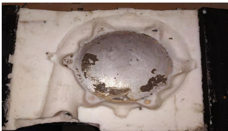
5 Сурет - Ұлудың сыртқы бетін құю үшін дайындалған пішін
