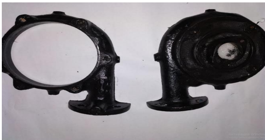
3 Сурет - Екі бөлікке бөлінген ұлу корпусы
